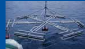
Eintrag mit Luft oder Sauerstoff mit Diffusor
